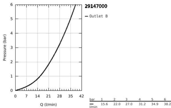
29 147 000 **SMARTCONTROL UNTERPUTZMISCHER MIT 1 ABSPERRVENTIL**
