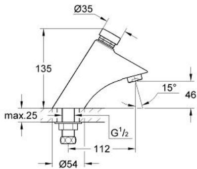
36 173 000 **CONTROPRESS SELBSTSCHLUSS-STANDVENTIL, 1/2"**
