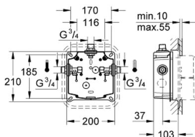
36 014 000 **EURODISC SE UP-EINBAUKASTEN**
