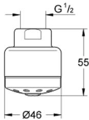
28 545 000 **RELEXA AEROSOLARM 45 KOPFBRAUSE 1 STRAHLART**
